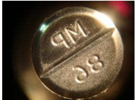
New EIP 下杵 過酷条件 40分。合計 100分打錠後
