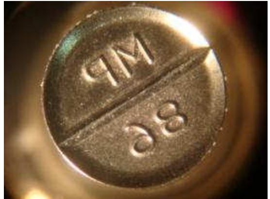
New EIP 上杵 過酷条件 40 分、合計 100 分打錠後
